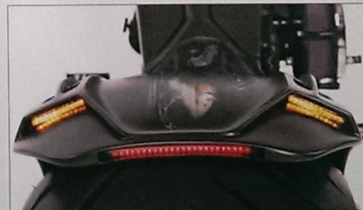
Flache Sache: Rückleuchten und Blinker sind im höhenverstellbaren Heck integriert
